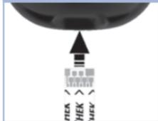
Inserte la tira reactiva en el medidor según la dirección de las flechas. El medidor se enciende y emite una señal sonora.
