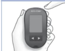
Pulse y suelte
